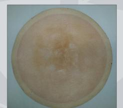
Figura 7 – Membrana contaminada após os experimentos.
